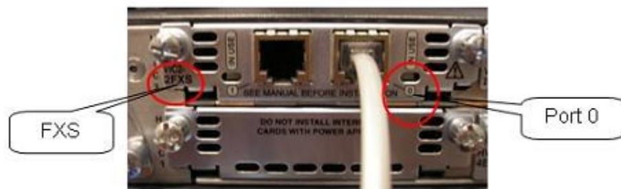
Сурет 2.14 - FXS және FXO интерфейстері
